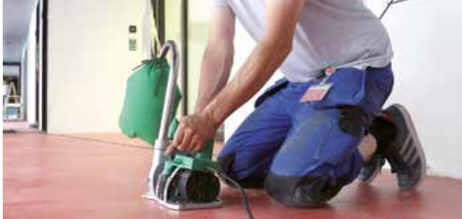
Potente accionamiento apto para los materiales PVC, PUR y linóleo.
