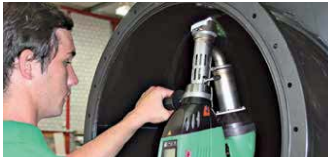
Simple auto-soldadura de radios interno.
