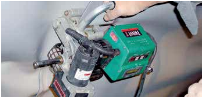
TWINNY T con práctico mango transversal para soldaduras en túnel realizadas por encima de la cabeza del operario.
