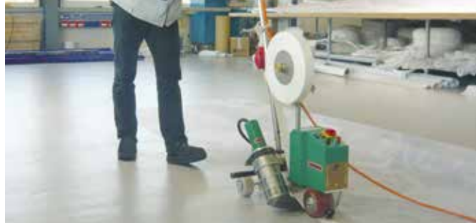
Soldadura de bandas a máxima velocidad.
